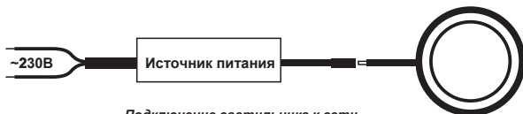
Подключение светильника к сети.
